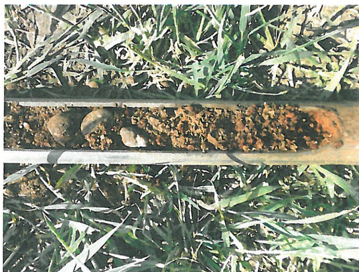
Foto č. 5: Výnos poloporušených vzorků zemin z geologické sondy GS-1.
